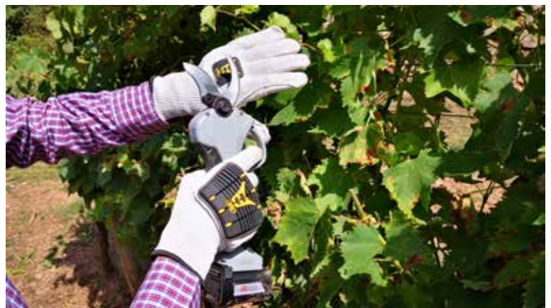
El tejido conductor potencia la transmisión eléctrica y permite el óptimo funcionamiento del sistema de seguridad CPS de las tijeras Arvipo.
